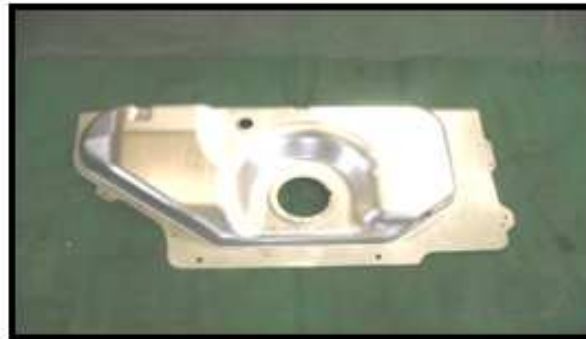
( KIA ) F/TANK UPR Material : SRNCEN 0.8 mm
