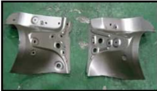
( PERODUA ) APRON,FR FENDER,RH/LH Material : SPC270E 0.8mm
