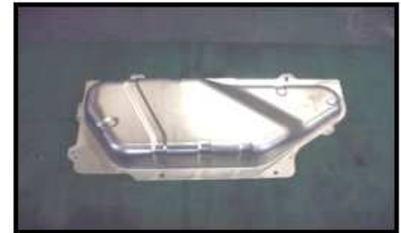
( KIA ) F/TANK LWR Material : SRNCEN 0.8 mm
